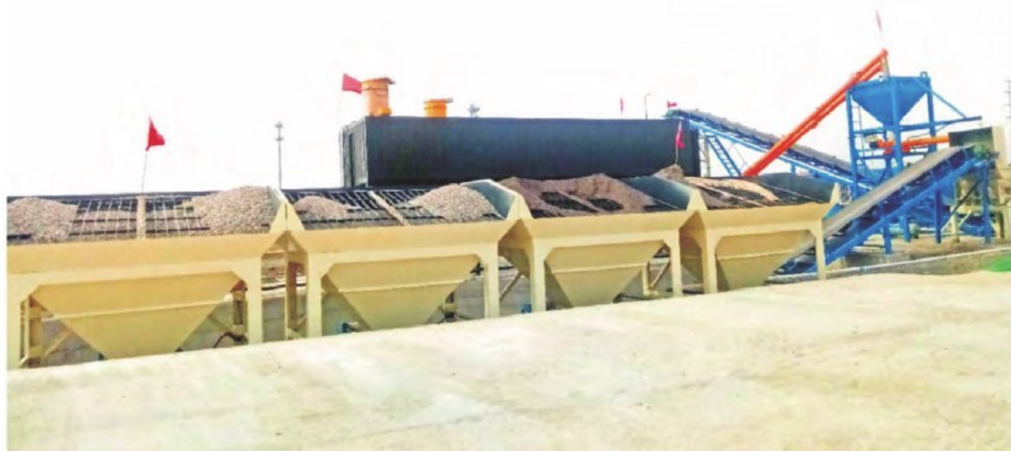
Usina de Solo Estabilizado AGO800 - Mongólia Interior
